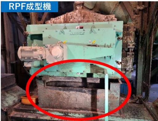
左写真がRPFを製造する当社の成型機です。押し出し式の成型機となっており、熱を加えながらRPFを製造します。
