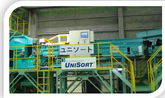
赤外線では材質の波長を読み取り、リサイクル燃料に向かない塩素系プラスチックを自動選別する機械「ユニソート」。
