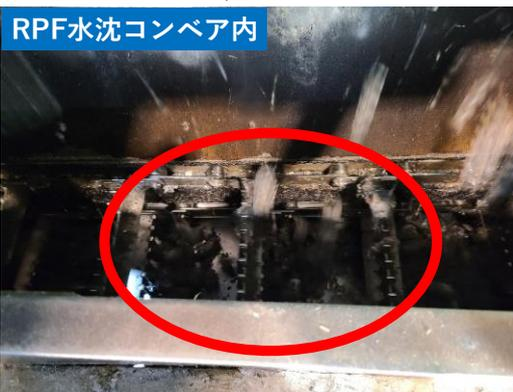
固形化されたRPFは製造直後は熱を帯びており、安全な温度へ下げるため、水を使用しています。当社の水使用量の多くを占めている非常に大事な工程になります。
