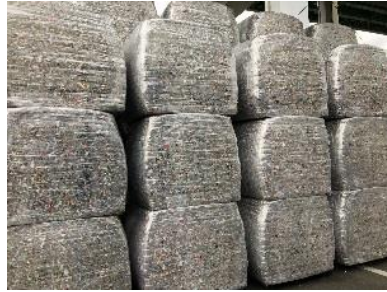
フラフ燃料を効率良く運送するための圧縮梱包。
