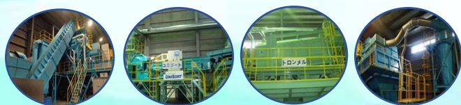
廃棄物を効率よく選別するために多くの選別機を導入しています。
