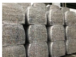
フラフ燃料を効率良く運送するために、圧縮梱包。
